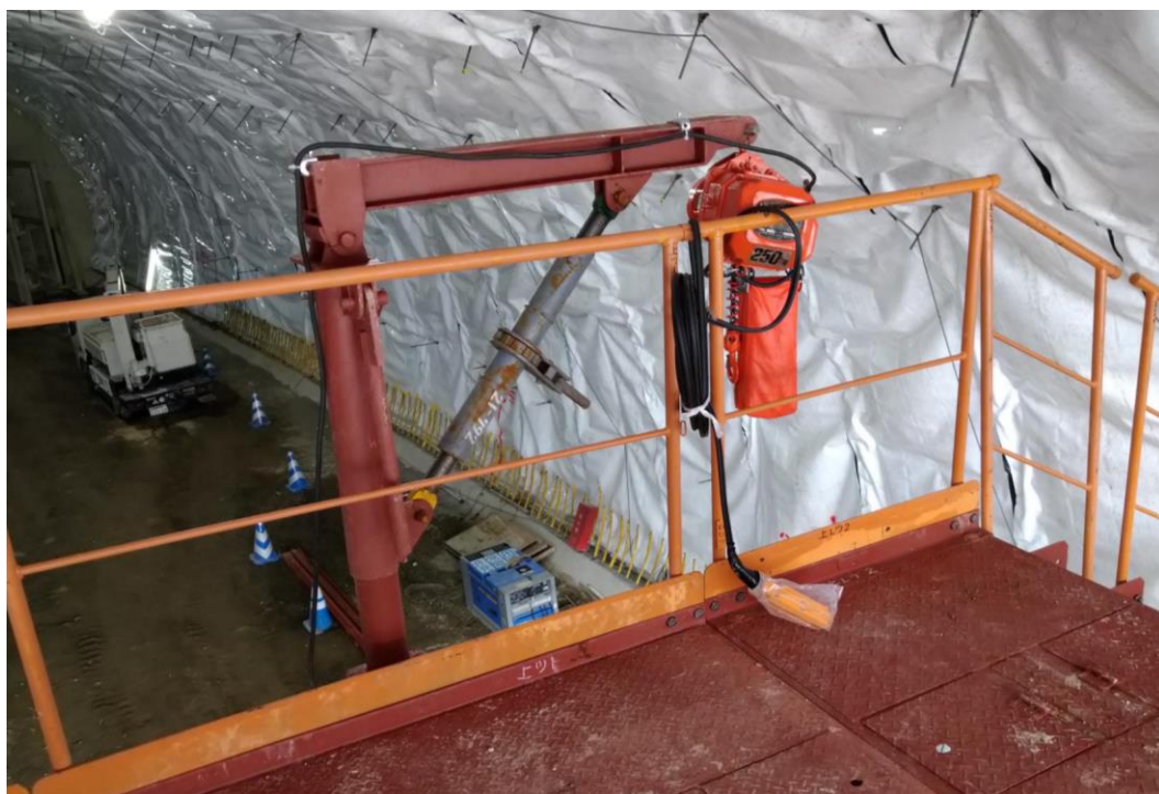
上記写真は250kg用です ※490kg用はアームの部材が異なります
