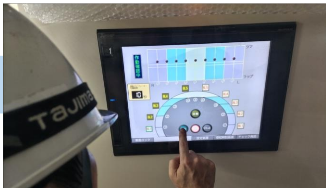
2. 締固めシステム → 型枠バイブレーター集中制御
